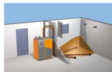
Pellets-Lagerraum mit Saugsonden
