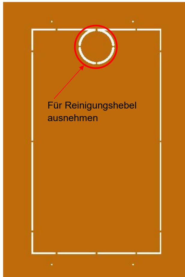
Falls Sie die Option automatische Reinigung gekauft haben, ist diese werkseitig bereits vormontiert. Um den rechten Seitenteil der Verschalung montieren zu können, muss zuvor der Durchbruch am Seitenteil hergestellt werden. Dies kann mit einem Seitenschneider durchgeführt werden. Die Öffnung ist sauber zu entgraten.
