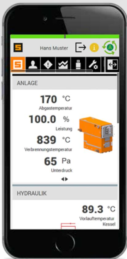
Die Schmid AG energy solutions überzeugt mit neuem Touch Panel. Das PersonalTouch visio ist eine komplette Neuentwicklung. Neben einem modernen Design und hoher Benutzerfreundlichkeit wurde darauf geachtet, dass die neuste Web-Technologie zum Einsatz kommt. Durch die konsequente Umsetzung dieser drei Punkte ist eine moderne Bedienung entstanden, welche den hohen Ansprüchen der Schmid Feuerungsanlagen gerecht wird.
