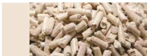
**Les granulés de bois proviennent de bois naturel et sont dotés d'excellentes propriétés techniques.** Les pellets cylindriques sont obtenus par compactage de sciure et de copeaux, sans adjonction de liants chimiques. Leur densité est de 1.5 à 2 fois supérieure à celle des bûches de bois. 2 kg de pellets remplacent 1 litre de mazout. La chaudière est alimentée par les granulés de bois automatiquement. En Suisse, le ravitaillement est assuré partout durant toute l'année.
